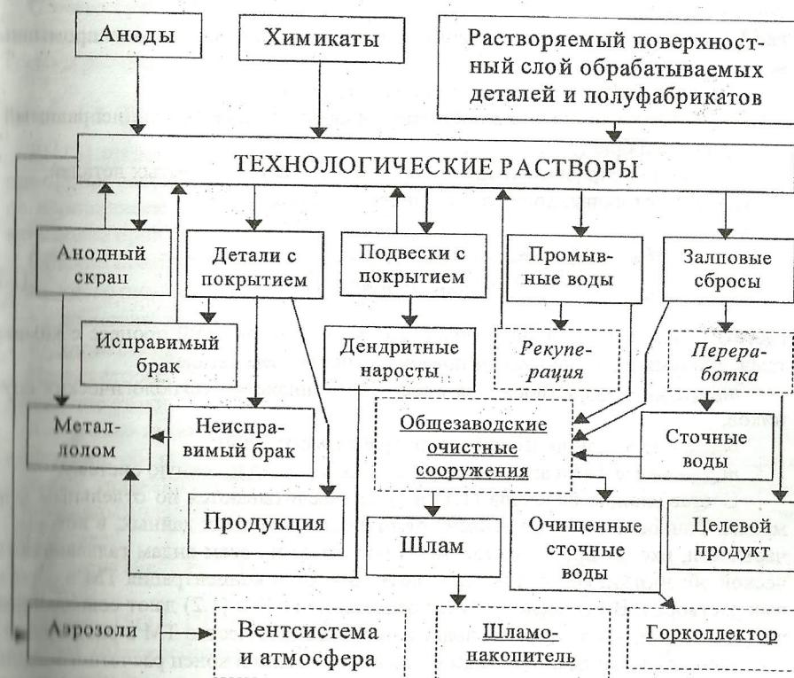
Рис. 1.1. Схема движения материальных потоков, содержащих ТМ, в гальванохимическом производстве
