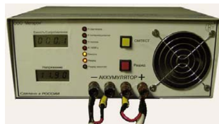
ООО «Мегарон» (Россия) Устройство для разряда свинцово-кислотных 12В батарей ёмкостью до 300Ач и измерения их параметров
