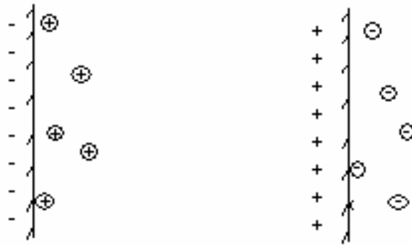
Рисунок 3.2.1 – Схема строения двойного электрического слоя.
