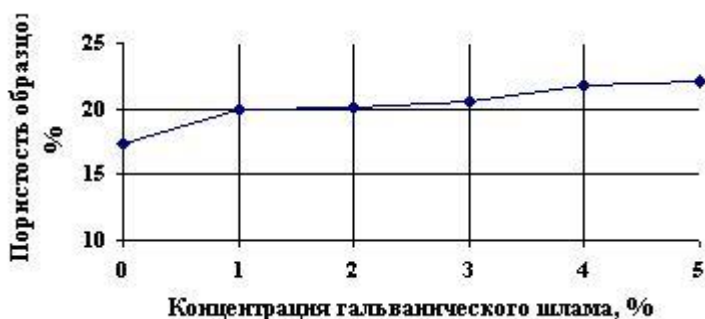
Рис. 1. Зависимость пористости образцов от концентрации гальванического шлама
