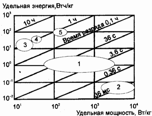
Рис.9. Зависимость удельной энергии от удельной мощности для ДСК (1), электролитических алюминиевых конденсаторов (2) и аккумуляторов различных типов: свинцово-кислотных (3); никель-кадмиевых (4); литиевых (5) [173]
