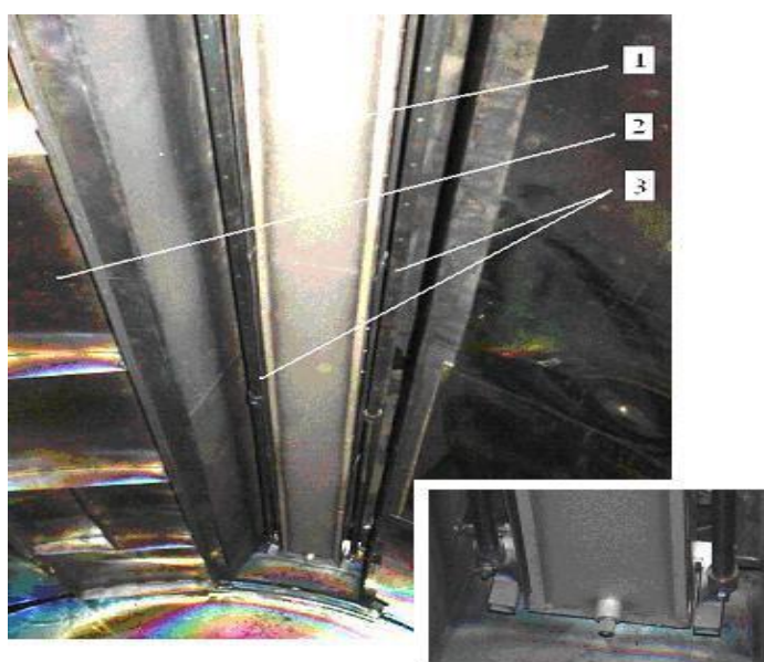
Рис.7. Планарный дуговой распылитель
