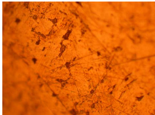
Рис. 2. Различные участки исходной поверхности образцов перед обработкой ( \times 1000 ): а – после штамповки; б – место реза штампом; в – место обрезки литника; г – предварительно фактурированная поверхность; д – основная поверхность; е – внешняя поверхность чашки под закрепку жемчужины
