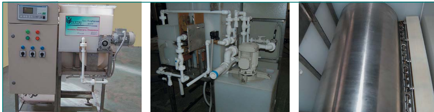
Рис. 9. Установка регенерация раствора травления печатных плат
